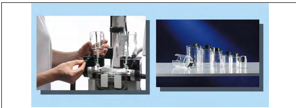
Рис. 15: Замена направляющих трубок
